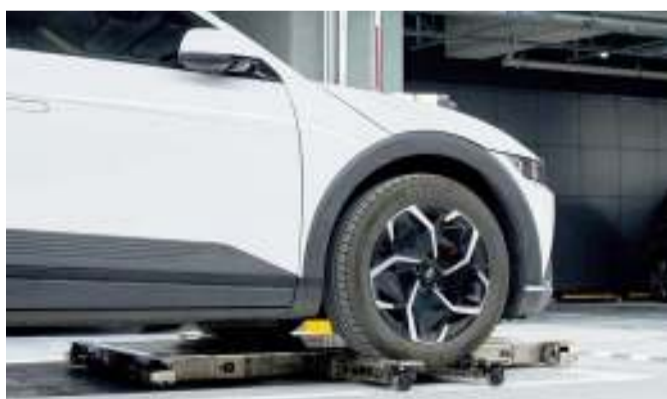
현대위아가 개발한 주차 로봇이 서울 성동구 팩토리얼 성수 지하주차장에서 차량을 주차하고 있다. (왼쪽 사진) 현대차·기아가 개발한 달이 딜리버리가 팩토리얼 성수에서 음료를 배달하는 모습.
