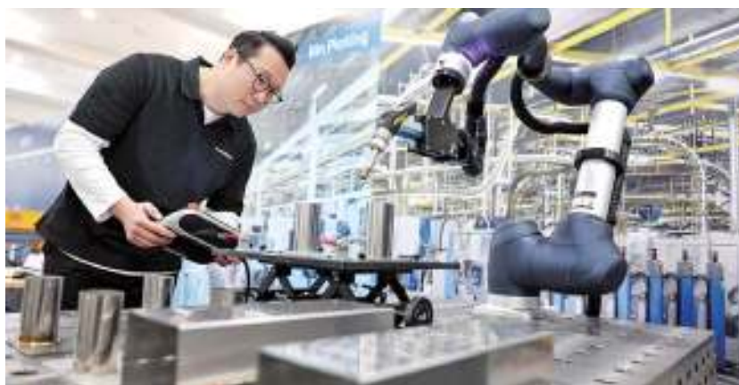
두산로보틱스 협동로봇 레이저용접 솔루션 모습.
