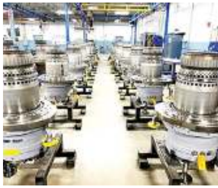
미국 뉴저지주 린든 열병합발전소 전경(왼쪽). 수소 혼소 발전의 주요 부품인 FlameSheet 연소기.
