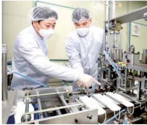
마스크 제조기업 레스텍에서 백나원(오른쪽) 공장장과 삼성전자 멘토가 마스크 귀끈 연결 상태를 점검하고 있다.
