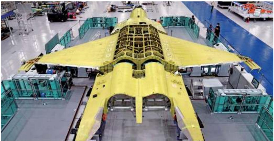
**KF-X 시제 1호기 최종조립** 한국형 전투기 KF-X가 최종 조립에 들어가 내년 상반기 일반인에게 처음 공개된다. 3일 방위사업청에 따르면 한국항공우주산업(KAI)은 KF-X 시제기 최종 조립을 시작했다. 2015년 12월 개발에 본격 돌입한 지 약 5년 만이다. 군은 내년 상반기 KF-X 시제 1호기의 최종조립을 마친 뒤 약 5년간의 지상시험 및 비행시험 등을 거쳐 2026년까지 개발을 완료해 한반도 영공을 수호할 계획이다. **연합뉴스**
