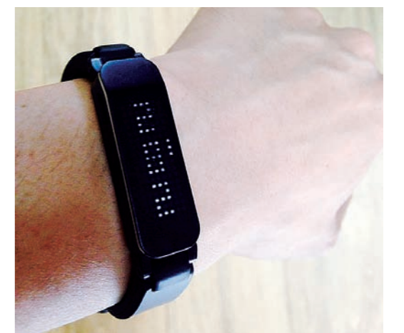
직토 워크 측면의 버튼을 두 번 누르면 걸음걸이 횟수가 나온다. 한 개의 버튼으로 시간, 걸음걸이 수, 걸음걸이 점수, 전화 등을 확인할 수 있다.
