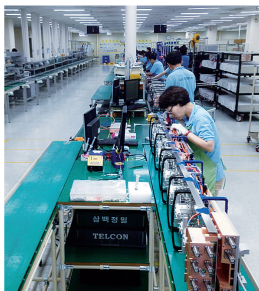
KMW 직원들이 경기도 화성 본사에 위치한 공장에서 무선통신 기지국 안테나를 조립하고 있다.
