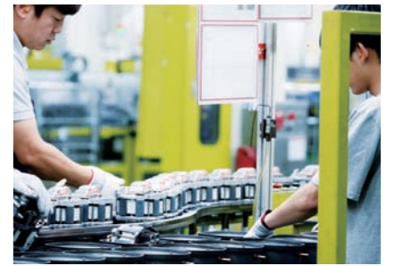
경남 창원시 가음정동에 위치한 창원 1공장 내 냉고 컴프레서 생산라인에서 인버터 리니어 컴프레서를 만들고 있다. 사진제공 LG전자
