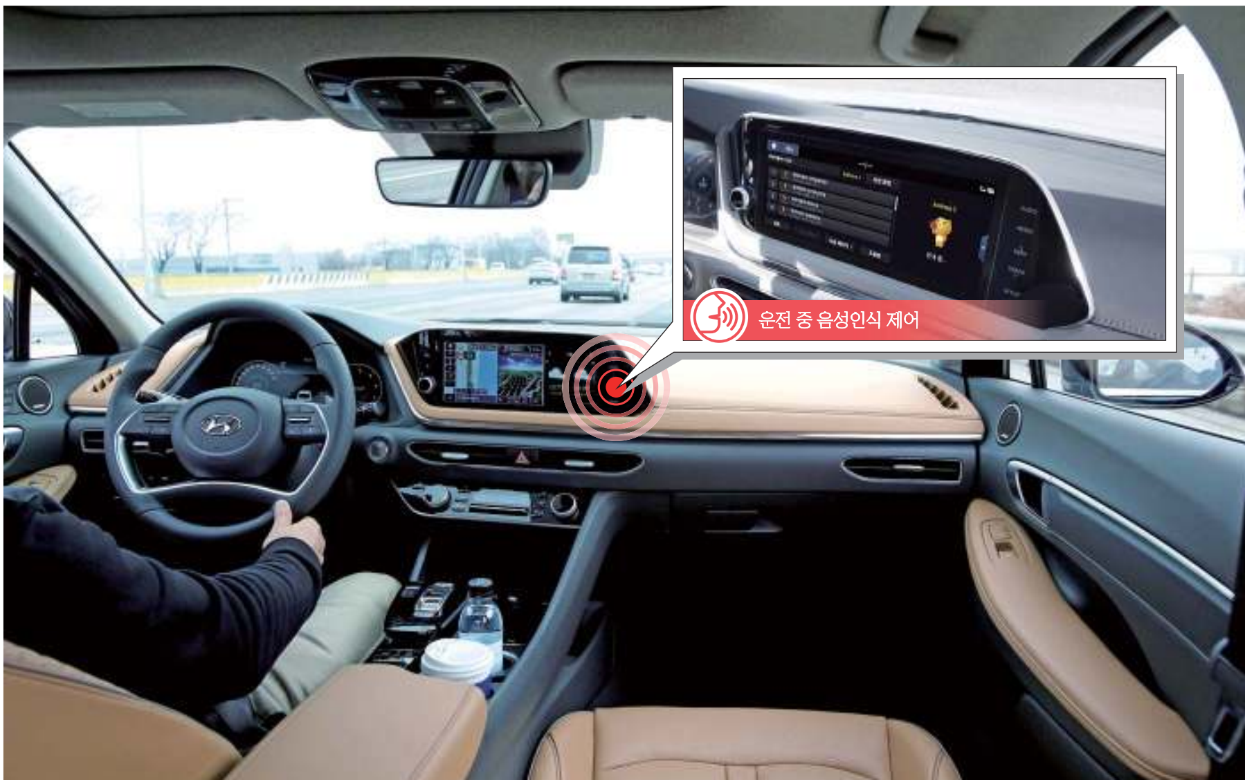
커넥티드카와 자율주행 기술이 발달하면서 운전자와 자동차의 비접촉(터치리스·touchless) 제어 장치가 증가하고 있다. 다양한 스위치가 손가락을 스치기만 해도 작동되고 음성인식 제어를 통해 편의장비와 정보센터 등에 접속할 수 있다. 사진은 현대차 8세대 쏘나타에 장착된 카카오 음성 제어 기능. 음성 명령을 시작하면 센터 모니터에 카카오 캐릭터가 등장한다. 사진제공 현대차·카카오아이
