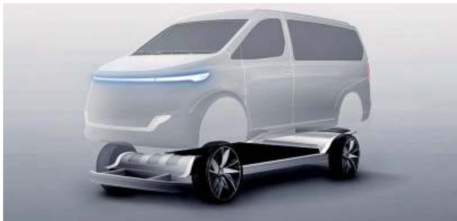
배터리·모터를 패키지로 묶고 차체를 따로 올리는 스케이트보드형 전기차 이미지. 사진제공 현대기아차
