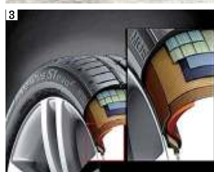
1 타이어 제조일자(DOT 코드)는 옆면에 자리한 네 자리 숫자다. 앞쪽 두 자리는 생산 주, 뒤쪽 두 자리는 생산 연도를 뜻한다. ‘0819’는 2019년 8번째 주에 생산된 제품. 2 방탄 타이어를 단 차량. 3 런플랫 타이어는 타이어 옆면, 즉 사이드월이 탄탄해 펑크가 나도 주저앉지 않는다.
