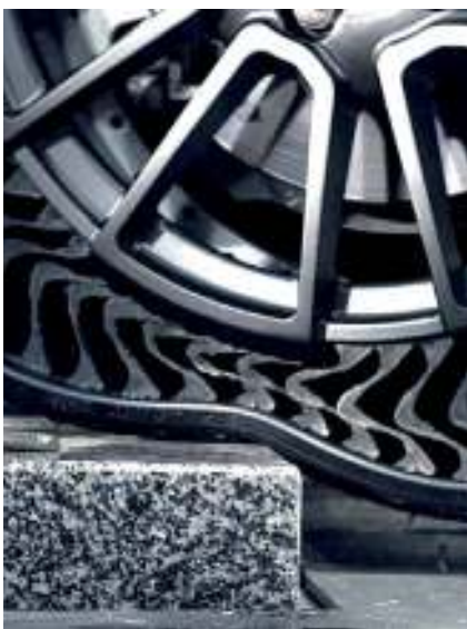
미쉐린과 GM이 상용화를 위해 공동 개발 중인 ‘에어리스 타이어’. 펑크가 나지 않고 못이 박히면 박힌 채로 내달린다. 노면 요철에 따른 충격 흡수력이 뛰어나 승차감이 월등하다.
