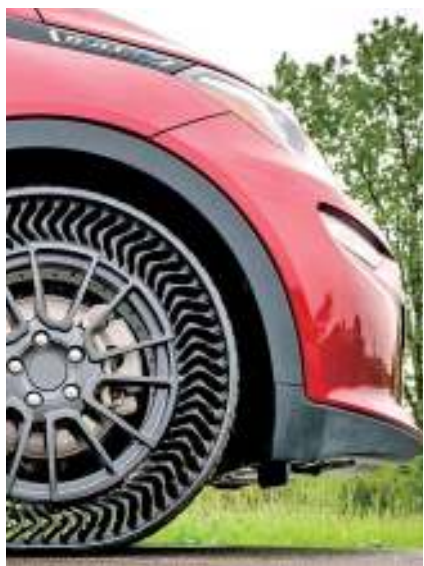
미쉐린과 GM이 상용화를 위해 공동 개발 중인 ‘에어리스 타이어’. 펑크가 나지 않고 못이 박히면 박힌 채로 내달린다. 노면 요철에 따른 충격 흡수력이 뛰어나 승차감이 월등하다.
