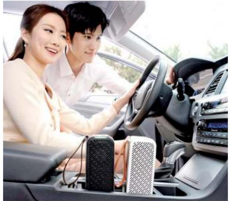
**언제 어디서나 휴대용 공기청정기** LG전자가 자동차, 유모차, 공부방에서 사용할 수 있는 휴대용 ‘LG 퓨리케어 미니 공기청정기’를 22일 출시한다. 퓨리케어 미니의 포터블 PM1.0 센서는 제품을 세우거나 눕히거나 상관이 없이 크로미세먼지까지 감지한다. 약풍으로 작동할 경우 도서관에서 발생하는 소음 수준인 약 23dB(데시벨) 정도의 소음이 발생한다. 사용자는 USB 타입-C 단자를 이용해 간편하게 배터리를 충전할 수 있다. 한 번 충전하면 최대 8시간 사용할 수 있다. 신제품의 무게는 생수 한 병과 비슷한 530g이다. 화이트, 블랙 2가지 색상으로 출시되며 가격은 출하가 기준 30만9000원이다. 필터는 3개 한 묶음 기준 3만 원이다. 사진제공 LG전자
