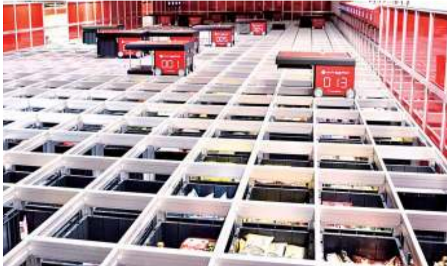
롯데 오토프레스 의왕센터는 주문을 받고 포장까지 7분 안에 이뤄지는 고효율 창고관리 시스템인 'GTP(Goods-To-Person) 피킹 시스템' 도입했다. 사진은 오토프레스 로봇이 상온상품을 바구니에 담는 모습. 사진제공 롯데쇼핑
