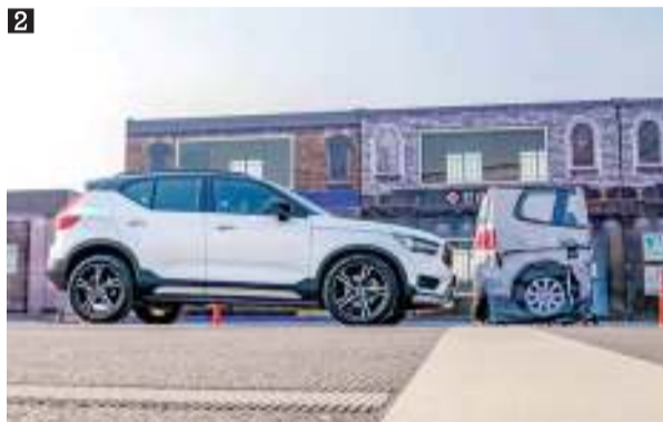
1 경기도 화성시 송산면 한국교통안전공단 자동차안전연구원 자율주행 실증도시 K-시티 교차로의 모습. 실제 가상도심을 재현해 자율주행차의 다양한 시험주행 환경을 만들었다. 2 긴급제동장치(AEB)를 장착한 볼보 XC40이 가상의 장애물(빨론 더미) 앞에 스스로 정확하게 멈춰 섰다. 3 K-시티는 도심과 외곽도로, 고속도로 등 다양한 주행 조건을 갖추고 있다. 4 향후 약천후와 전파교란 지역 등 갖가지 환경까지 염두에 두고 고도화 작업에 나설 계획이다. 터널을 빠져나온 자율주행시험차들의 모습. 김준형 기자 junior@연합뉴스
