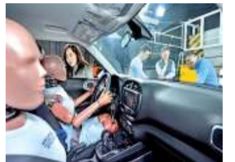
현대기아차가 2차 충돌까지 염두에 두고 개발한 에어백 시스템.
